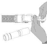
Den Zusatzadapter IN das Rohr stecken, die Teile a) und b) gegeneinander drehen, so daß der Adapter sich im Rohr aufspreizt bis er fest sitzt. Dann auf das herausstehende Teil den STUFENLOS-ADAPTER wie oben gezeigt anbringen.
