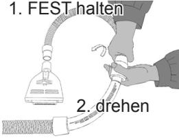
**STANDARD - Rohre mit Aussen-Durchmesser 32-38mm:**
